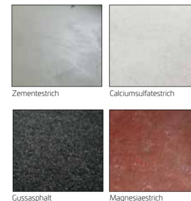
Zementestrich Calciumsulfatestrich Gussasphalt Magnesiaestrich
